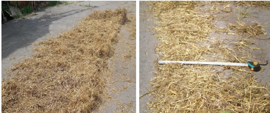
Рисунок 2. Визначення довжини шляху, що пройшов мобільний розкидач соломої підстилки та ширини смуги розкидання
