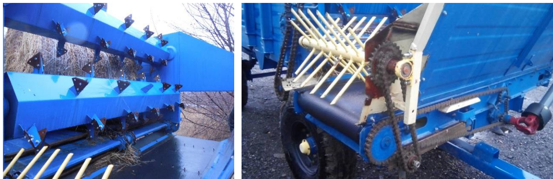
Рисунок 1. Загальний вид обладнання для технологічного процесу внесення солом'яної підстилки з роторно-пальцевим робочим органом
