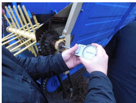
Рисунок 4. Визначення частоти обертання валу робочого органа та валу відбору потужності
