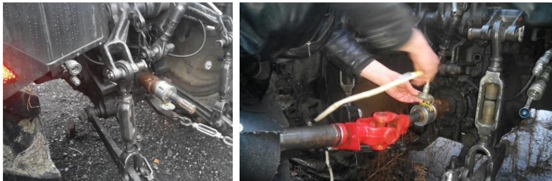
Рисунок 3. Визначення крутного моменту на валу відбору потужності трактора
