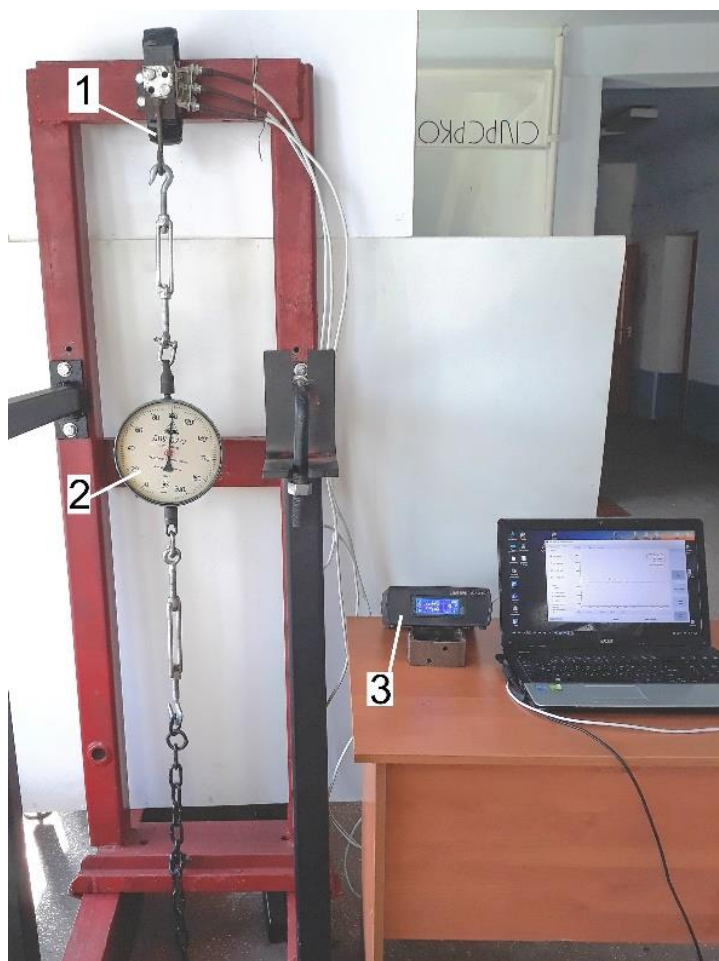
Рисунок 1.12 – Процес тарування тензоланки на стенді.
