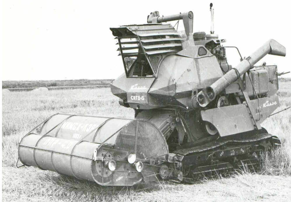
Рис. 2.1.5. Загальний вигляд експериментального комбайну з двобарабанним обчісуючим пристроєм
