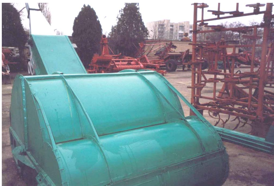
Рис. 2.1.14. Загальний вид причіпної збиральної машини
