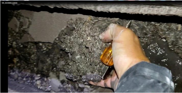
Залишки вапняного молочка разом зі сторонніми включеннями абразивного характеру (пісок, мілкий щебінь, шлам)
