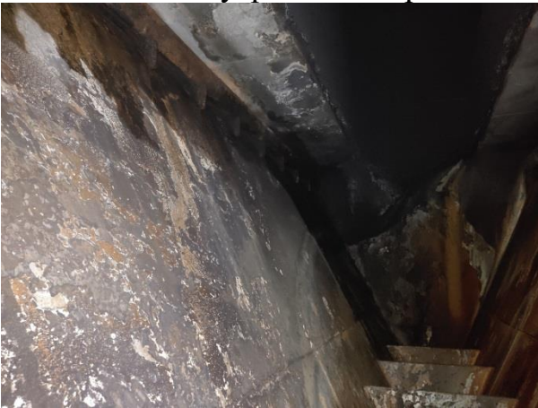
Відкладення з гумової прокладки оглядового вікна
