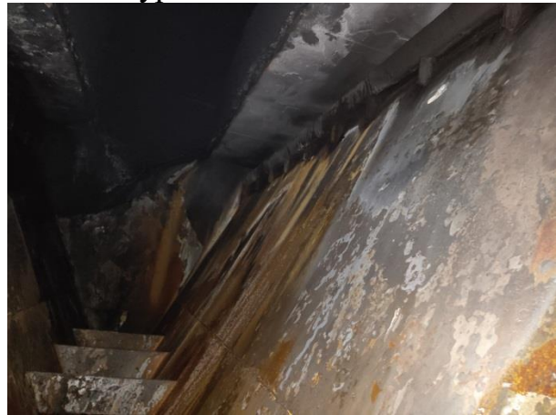
Товщина відкладення з гумової прокладки оглядового вікна 3 мм
