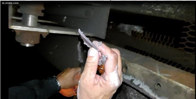
Відкладення з бокової вертикальної стінки оглядового вікна
