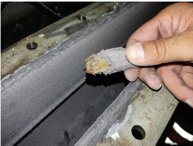
Сторонній предмет, що закупорив отвір
