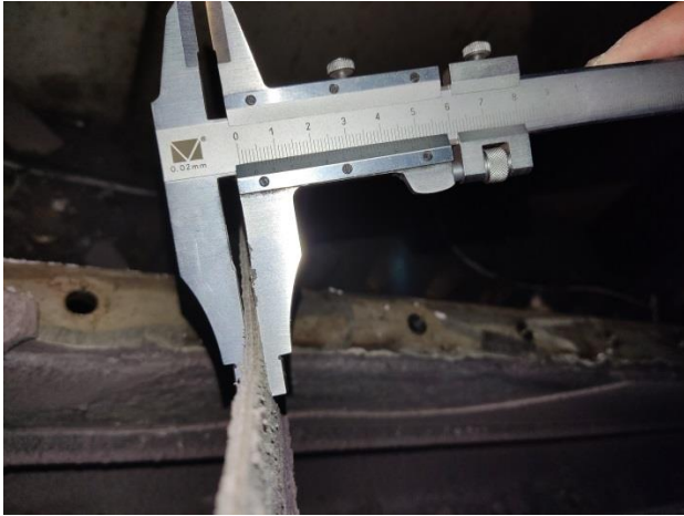
Товщина відкладення з бокової стінки 4 мм
