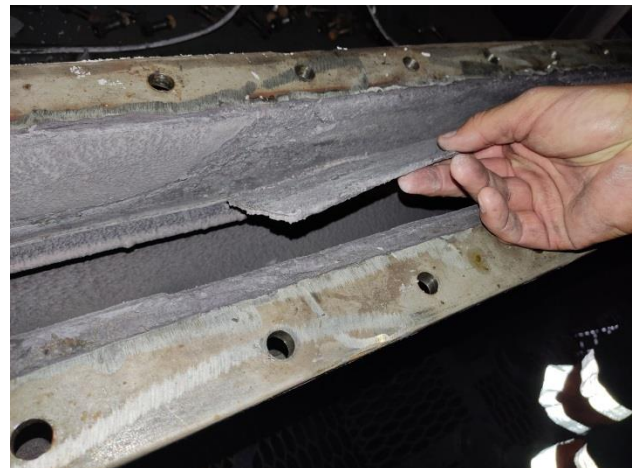
Зняття відкладення з бокової вертикальної стінки
