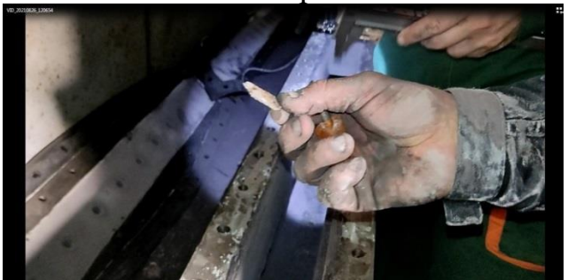
Сторонній предмет, що закупорив отвір
