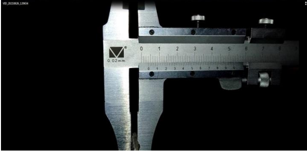
Товщина відкладення з кришки до 4 мм
