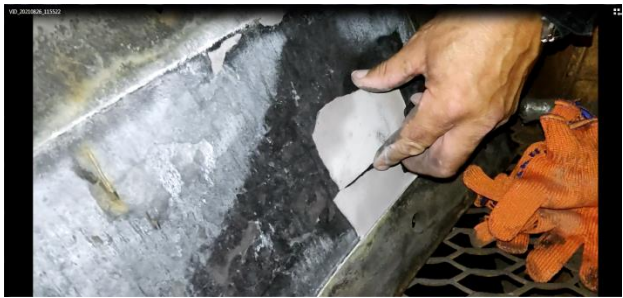
Відкладення з гумової прокладки оглядового вікна
