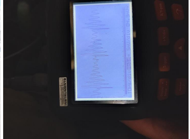
Перевірка сигналу на водяному контурі охолодження компресора № 2 ВВ-50 Теплообмінник пластинчатий Термекс. Сигнал стабільний
