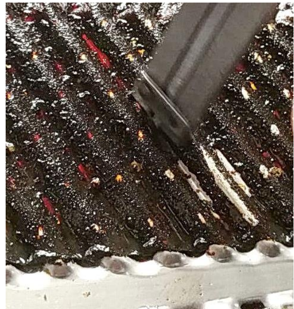
Рис. 6. Вигляд пластини тепломіннику до випробувань (закоксована олива на зворотному боці цієї ж пластини рис. 5)
