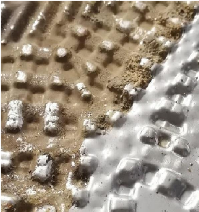
Рис. 5. Вигляд пластини тепломіннику до випробувань (накипу на водяному боці пластини)
