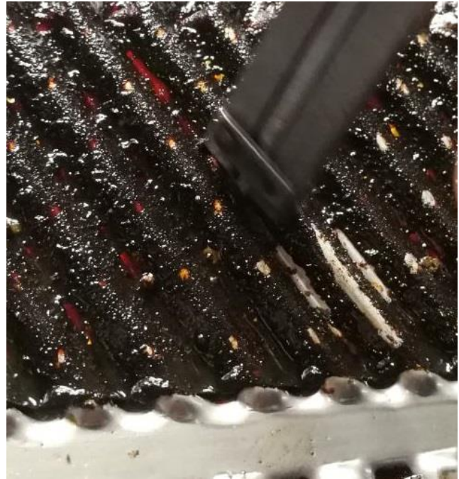
Рис. 6. Вигляд пластини тепломіннику до випробувань (закоксована олива на зворотному боці цієї ж пластини)
