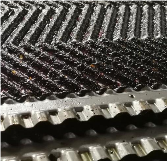
Рис. 1. Стан пластини без застосування приладу підготовки води
