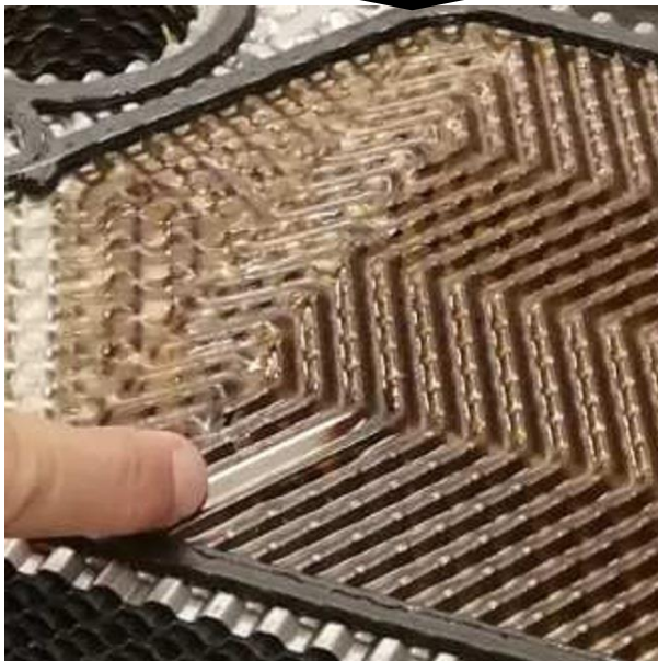
Рис. 5. Вигляд пластини тепломіннику до випробувань (накипу на водяному боці пластини)
