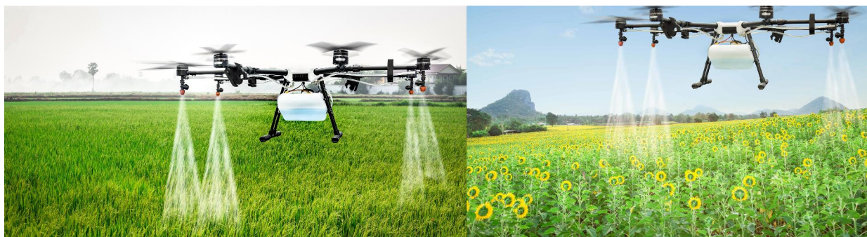
Рисунок 1.6 – Внесення агрохімікатів і біопрепаратів способом розприскування за допомогою дронів
