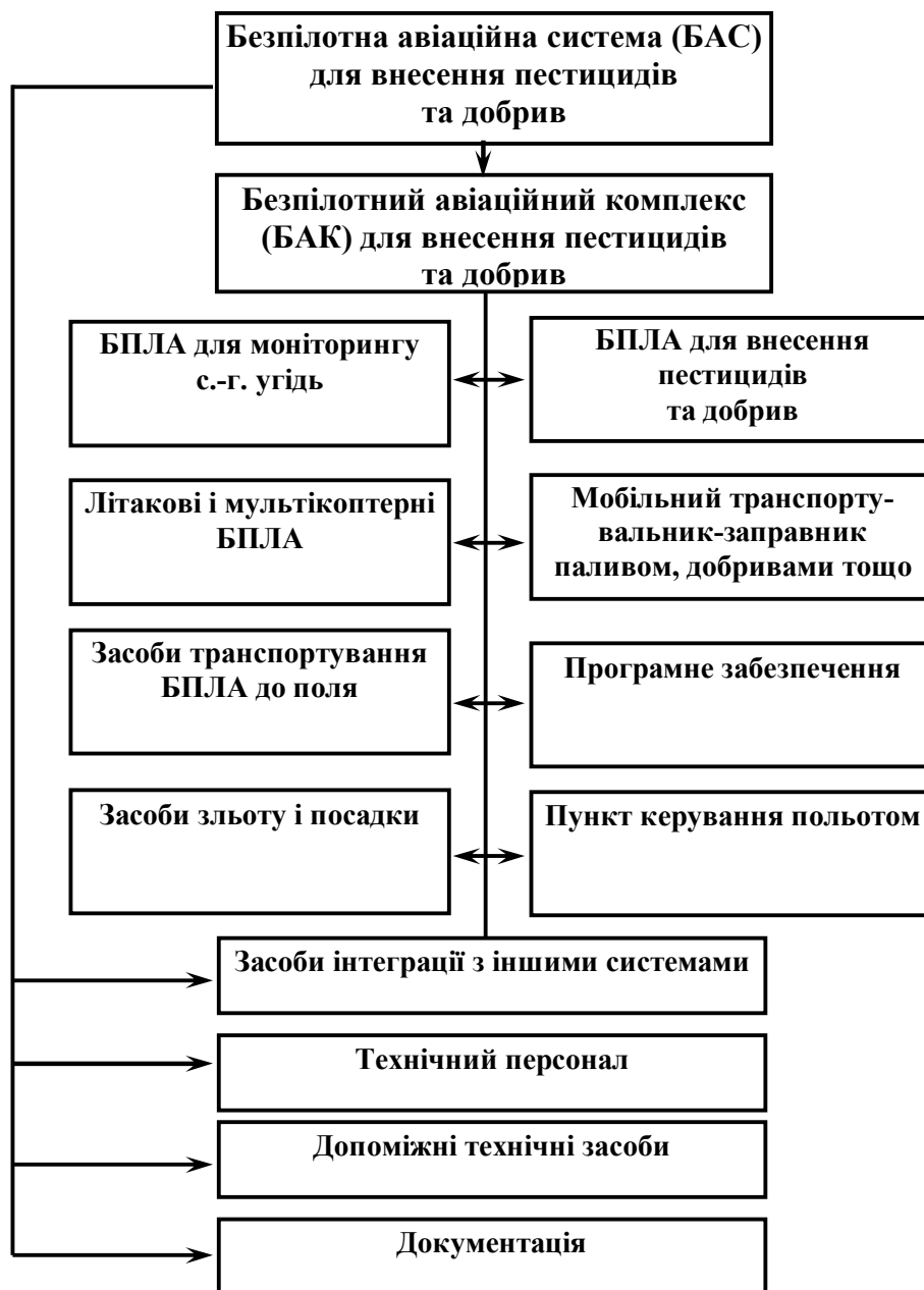
Рисунок 2.1 – Блок-схема безпілотної авіаційної системи для внесення добрив і пестицидів
