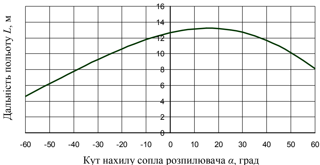
Рисунок 2.6 – Залежність дальності L польоту частинки технологічного матеріалу кинуті з висоти 20 м з початковою швидкістю руху V_0 = 2 м/с від кута \alpha нахилу сопла розпилювача відносно лінії горизонту
