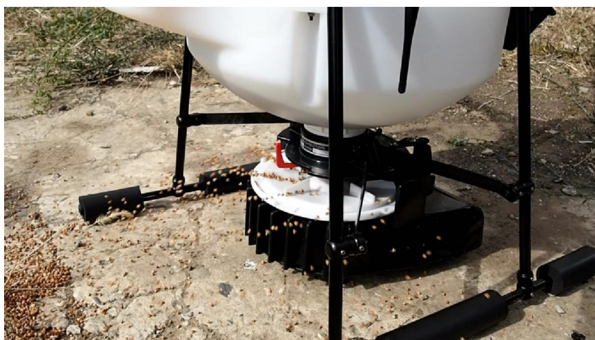
Рисунок 1.7 – Спосіб відцентрового розкидання технологічних матеріалів за допомогою дрона
