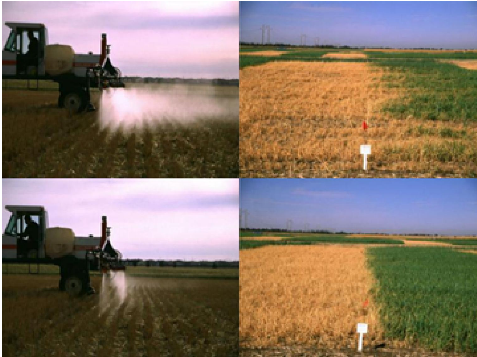
Рисунок 3.1 – зверху результати роботи традиційної форсунки, унизу – інжекторної
