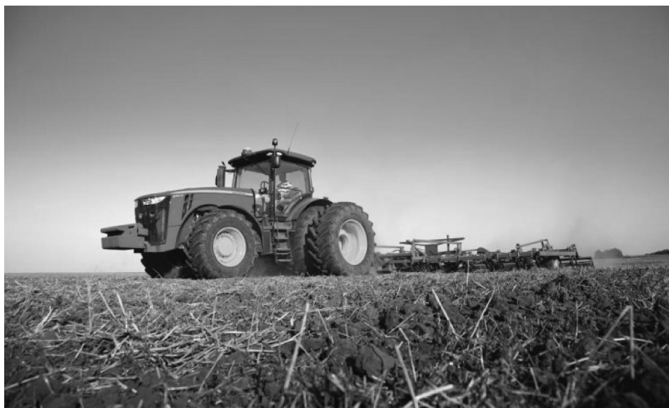
Рисунок 1.4 – Ешелонований орний агрегат на базі трактора John Deere
