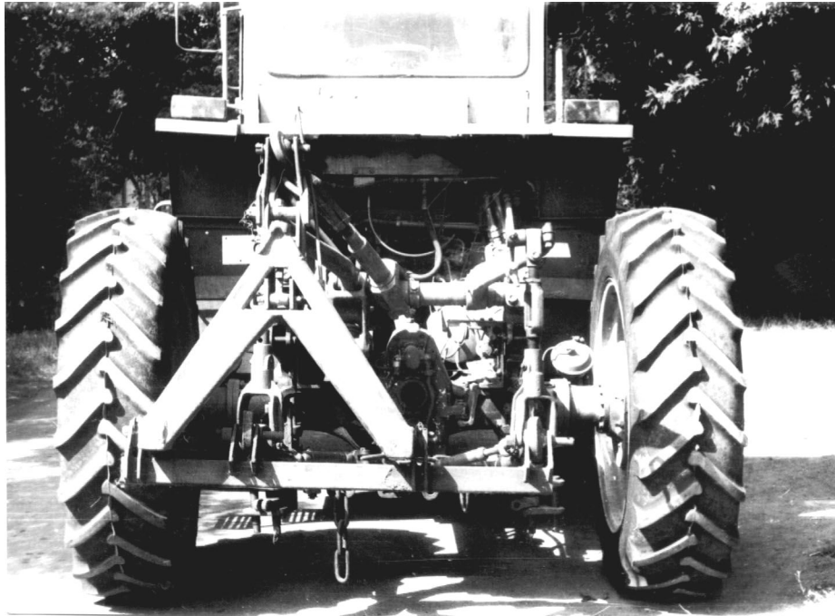
Рисунок 2.5 - Схема установки зчіпного пристрою на тракторі ХТЗ-16131
