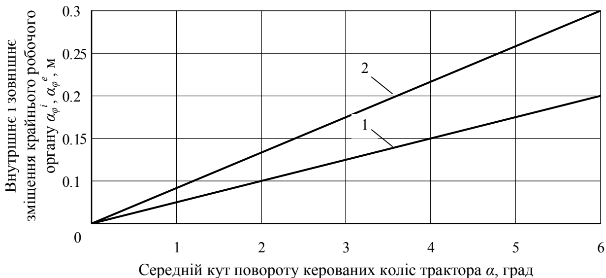
Рис. 3.9 – Внутрішнє \alpha_\varphi^i (1) і зовнішнє \alpha_\varphi^e (2) зміщення крайнього робочого органу в залежності від кута \alpha повороту керованих коліс трактора
