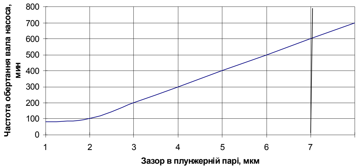
Рисунок 1.5 - Залежність пускової частоти обертання колінчатого вала двигуна від зазору в плунжерній парі
