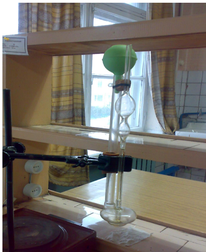
Рисунок 3.2 – В'язкозиметр при визначенні в'язкості біопалива
