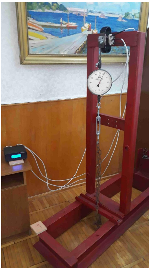
Рисунок 1.6 – Процес тарування тензоланки.
