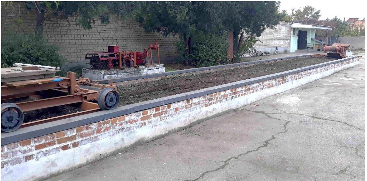
Рисунок 1.1 – Ґрунтовий канал ТДАТУ для дослідження робочих процесів ґрунтообробних машин.
