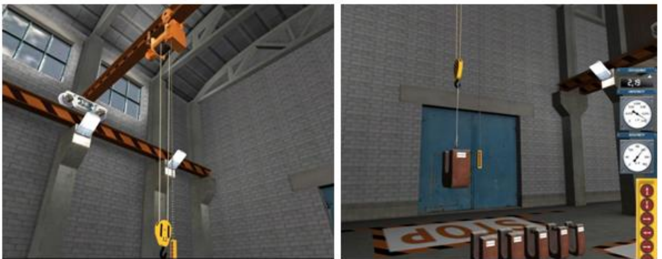
Рисунок 1 – Визначення ККД механізму підйому електроталі крана
