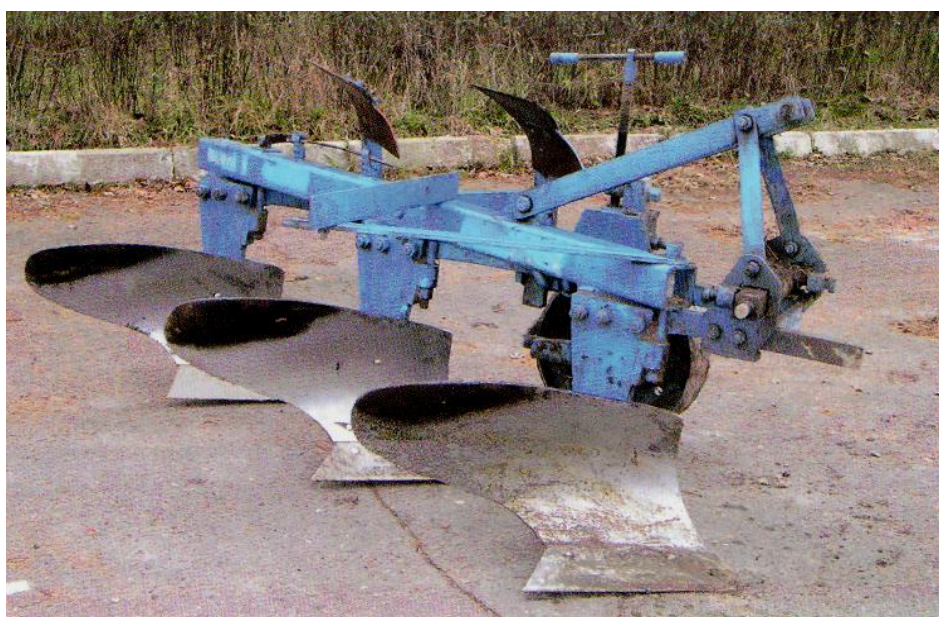
Рис. 2. Плуг навісний ПЛН – 4 – 35
