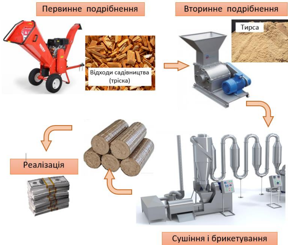
Рис. 1. Технологія виробництва паливних брикетів.
