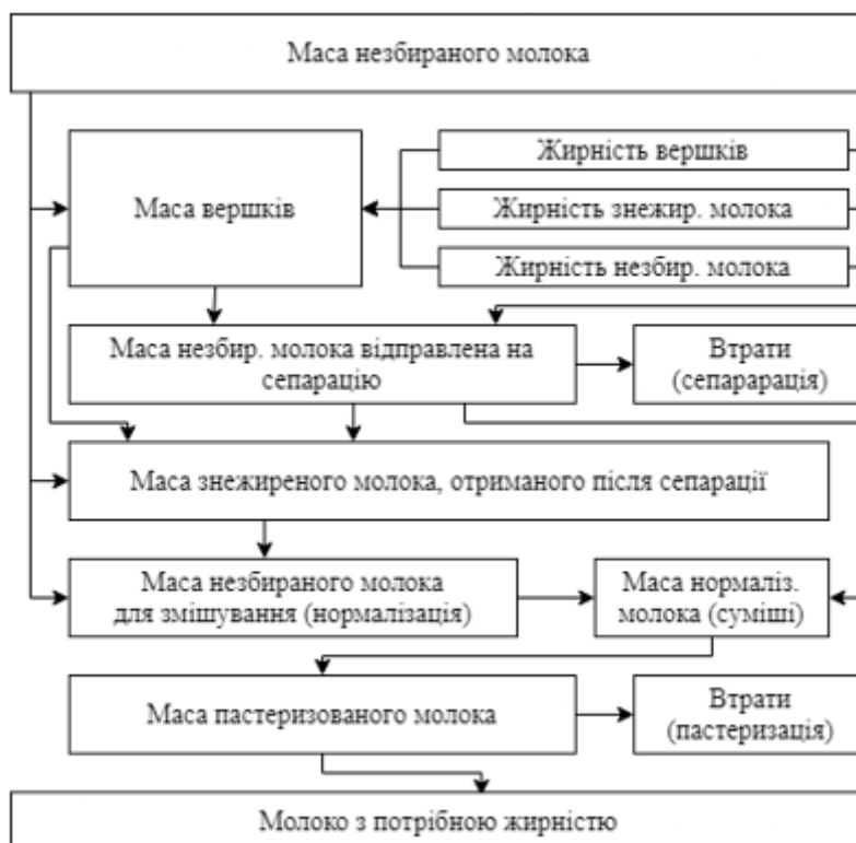
Рис. 1. Схема розрахунку компонентів при виробництві питного молока
