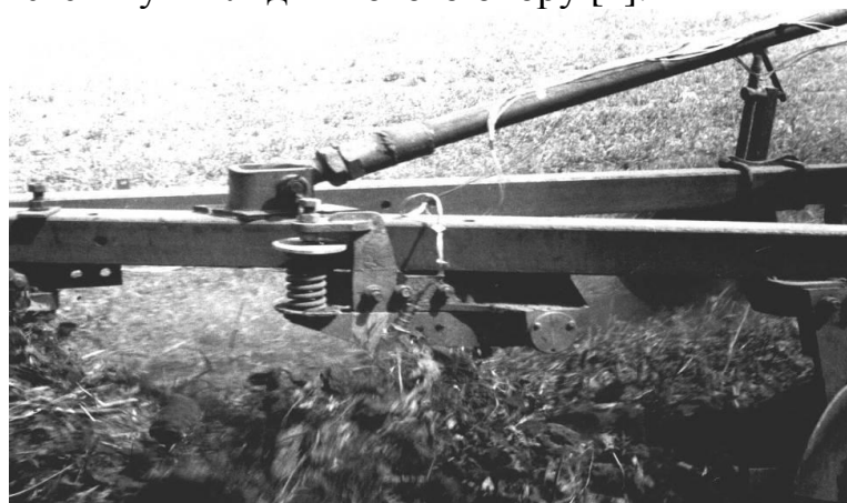
Рис. 1. Коливальна система корпус плуга на пружній підвісці.
