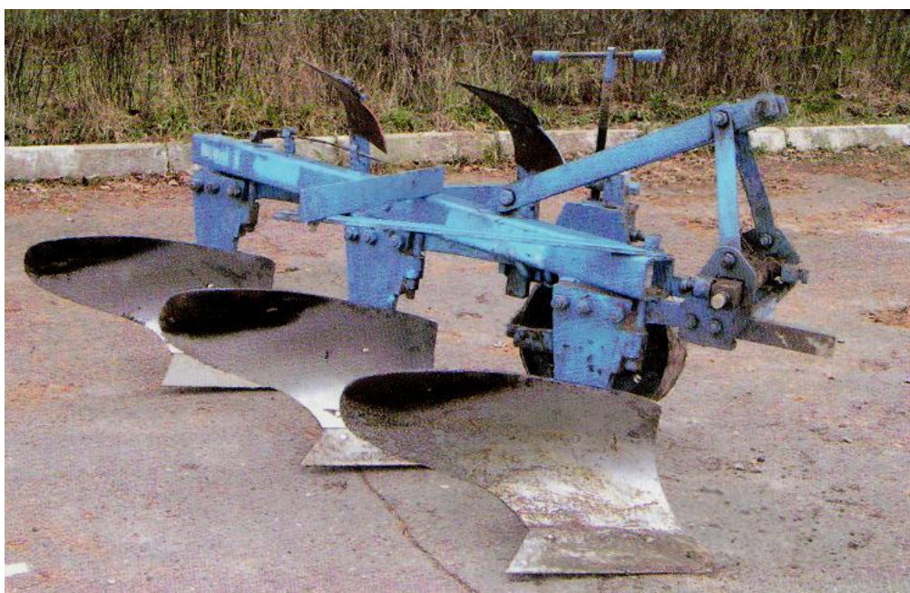
Рис. 5. Плуг навісний ПЛН – 4 – 35.
