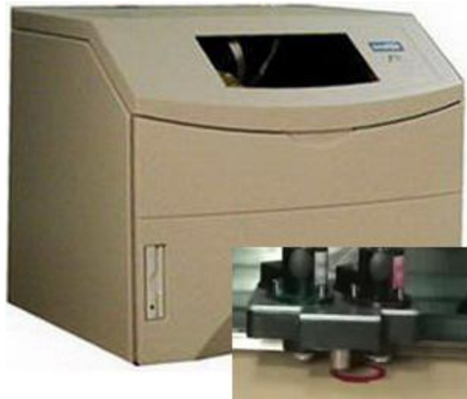
Рис. 5. Створення восківки на 3D-принтері.
