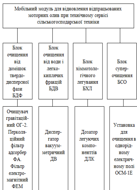
Рисунок 4. Структурна схема мобільного модуля для відновлення відпрацьованих моторних оливи
