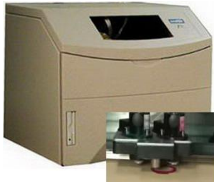
Рис. 5. Створення восківки на 3D-принтері.
