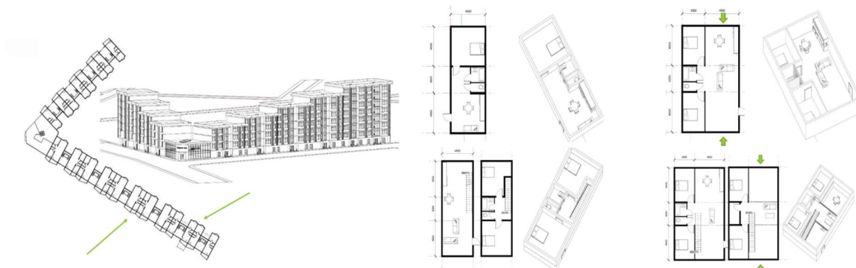
Рис.2. План типового этажа здания с двусторонним расположением квартир на северо-запад и юго-восток
