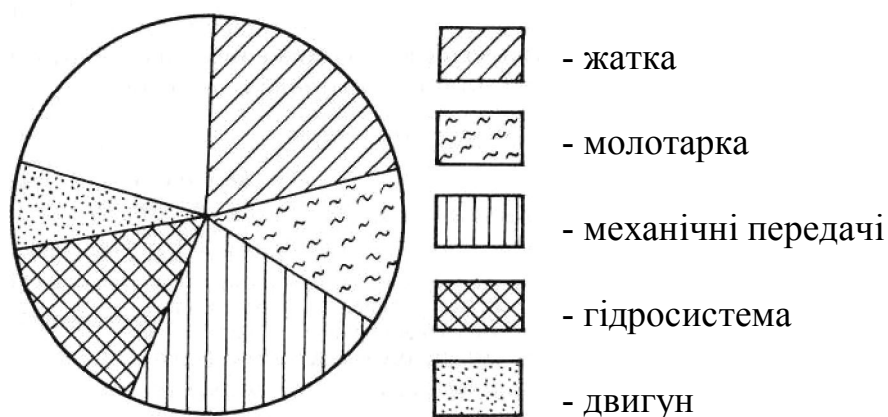
Рисунок 3.5 - Діаграма розподілу відмов вузлів по вузлах і агрегатах комбайнів "Дон-1500" за результатами випробувань у господарствах
