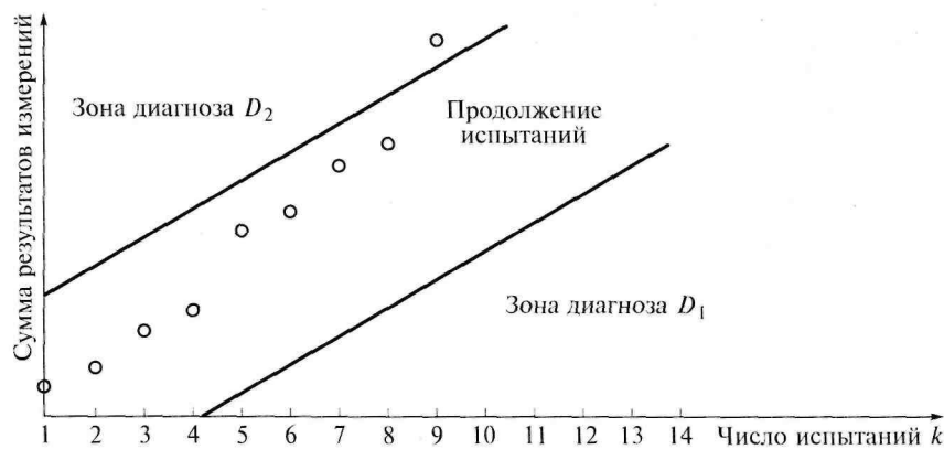
Рисунок 3.5. – Приклад графіка постановки діагнозу по методу послідовного аналізу контрольованого параметра
