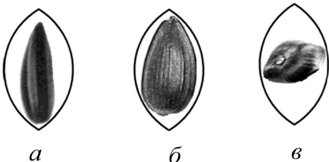
Рисунок 2.6 - Варіанти проходження сем'янки соняшнику через регульований отвір: а - по довжині; б - по ширині; в - по товщині
