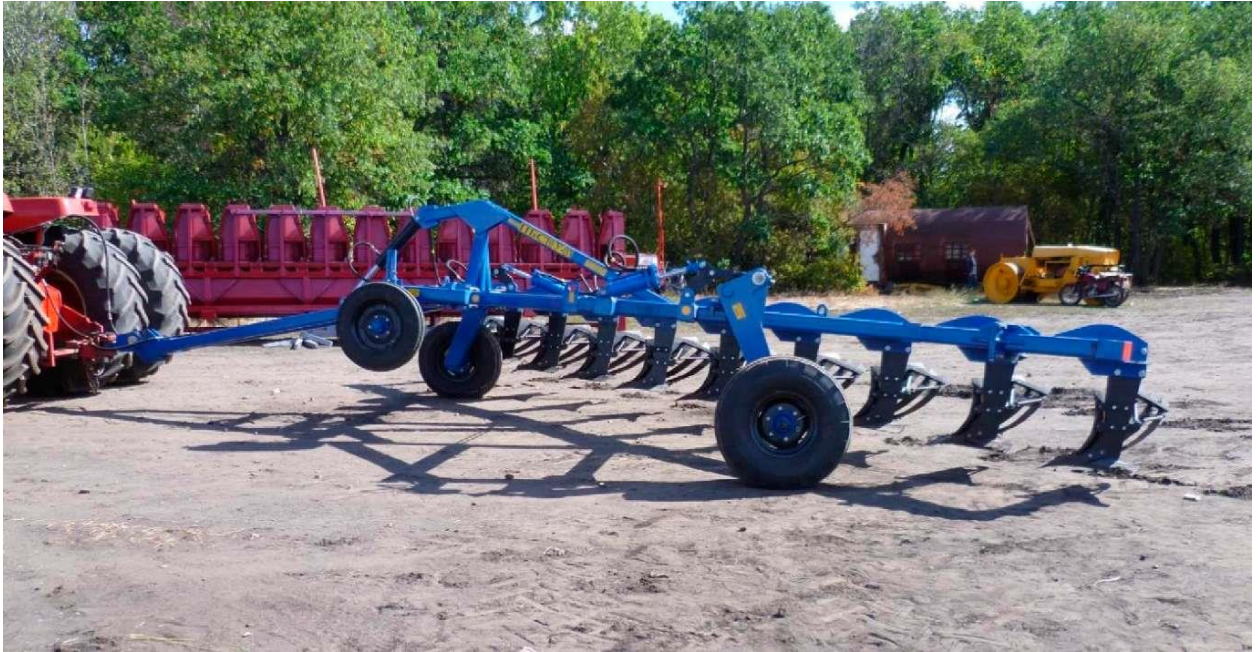
Рисунок 1.26 - Десятикорпусний причепний плуг у транспортному положенні
