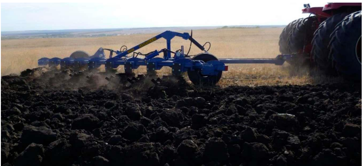
Рисунок 1.25 - Причепний десятикорпусний плуг в агрегаті з трактором Versatile Buhler 2425 (потужність 313 кВт) у роботі
