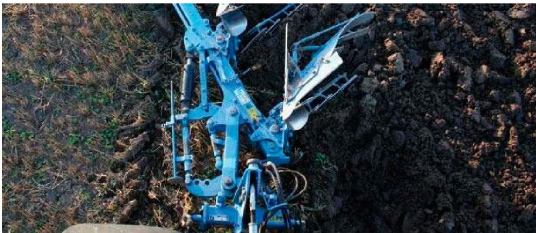
Рисунок 1.15 - Оборотний пристрій плугів фірми Lemken
