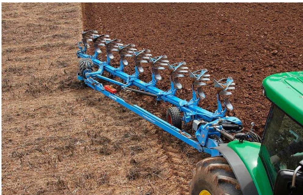
Рисунок 1.12 - Німецький напівначіпний плуг Lemken Diamant 12 в агрегаті з трактором John Deere, з опорою на колесо
