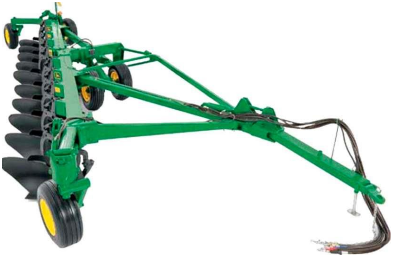
Рисунок 1.20 - Прицепной американский 10-ти корпусный плуг John Deere 3710
