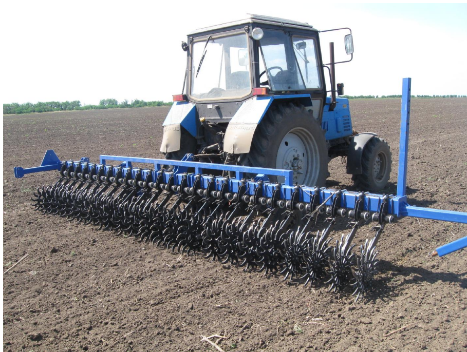
Рисунок 1.6 – Борона-мотика БР-6, виробництва ТОВ «Оріхівсільмаш» на експлуатаційно-технологічних випробуваннях науковцями кафедри МВЗ
