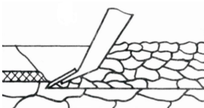
Рисунок 1.7 – Руйнація плужної підшви чизельним робочим органом
