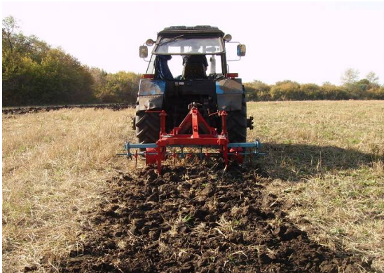
Рисунок 3.5 - Схема плоскоріза–глибокорозпушувача з комбінованим робочим органом для безвідвальної обробки ґрунту
