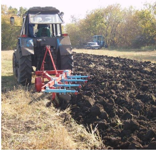
Рисунок 3.4 - Схема борозноутворювача і його установки на плуг
