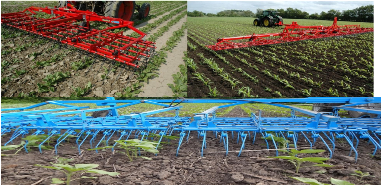
Рисунок 3.1 – Грунтообробні агрегати в складі пружинних борін на міжрядному обробітку просапних культур
