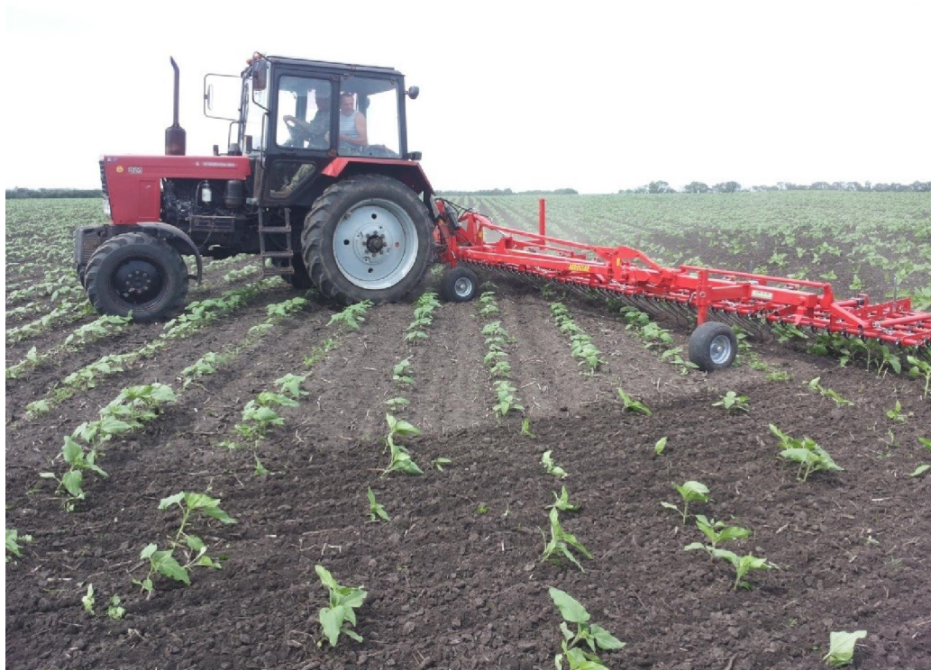
Рисунок 1.7 – Обробіток сходів просапних культур пружинною бороною поперек рядків
