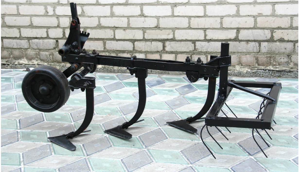
Рисунок 2.3 – Розробка додаткової боронувальної секції до просапного культиватора (патентовласник кафедра МВЗ ТДАТУ)
