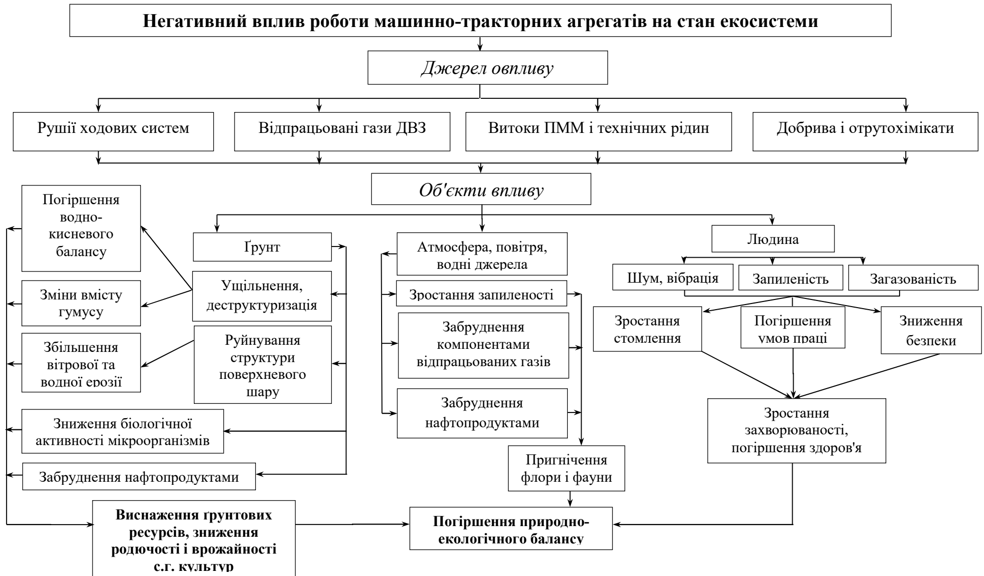
Рисунок 1.4 - Негативний вплив роботи машинно-тракторних агрегатів на стан екосистеми
