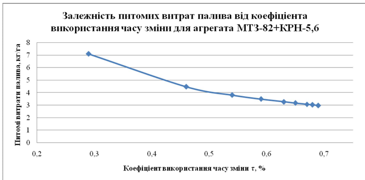
Рис 3.4 - Залежність питомих витрат палива від коефіцієнта використання часу зміни для агрегата МТЗ-82+КРН-5,6
