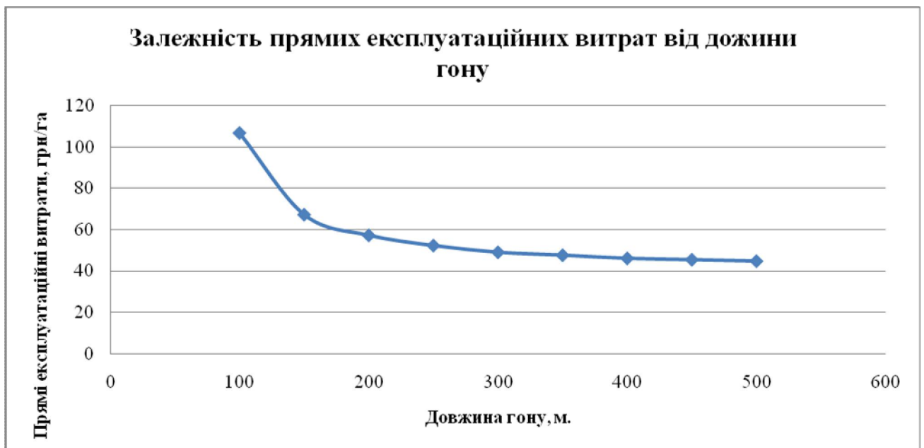
Рис 3.8 - Залежність прямих експлуатаційних витрат від довжини гону для агрегата МТЗ-82+КРН-5,6
