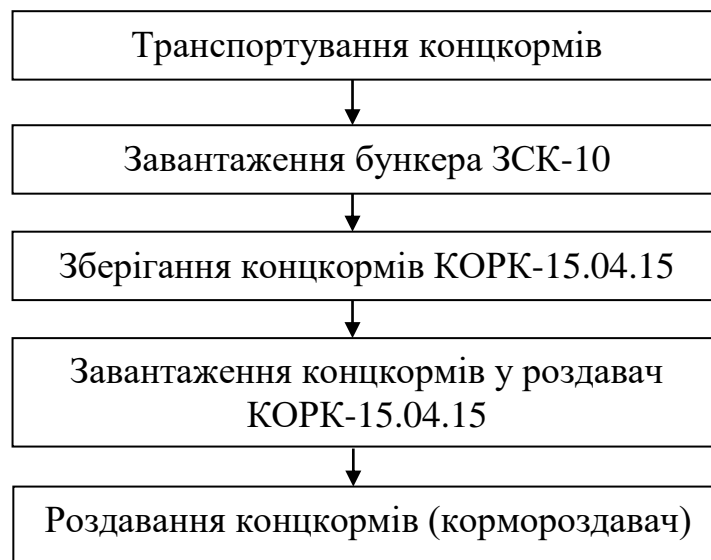
Рисунок 2.2 - Технологічна схема приготування і роздавання концентрованих кормів.
