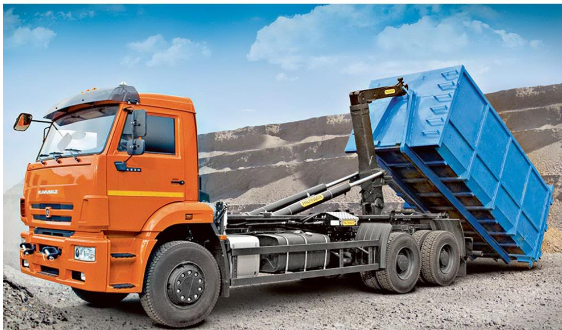
Рис. 1.2 – Зовнішній вид автомобіля КамАЗ з системою «мультиліфт»
