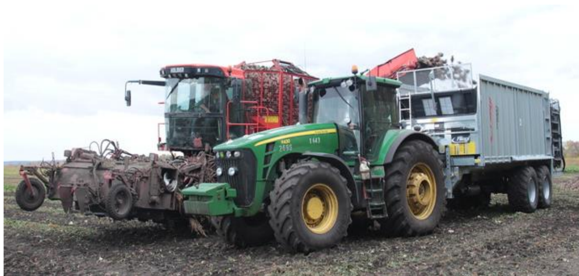
Рис. 1.5 – Система «мультиліфт» на тракторному причепі
