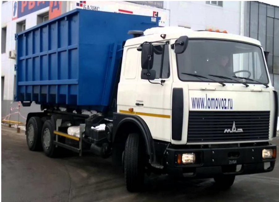
Рис. 1.3 – Зовнішній вид автомобіля МАЗ з системою «мультіліфт»
