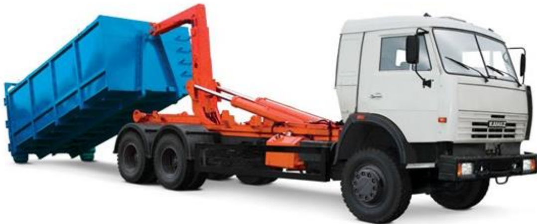
Рис. 1.1 – Автомобіль з системою «мультиліфт» фірми «Partek»
