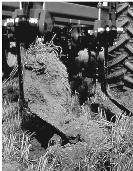
Рисунок 2.3 – Робота похилих стійок плуга-розпушувача Paraplow.
