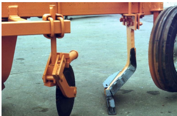
Рисунок 2.4 – Робочий орган плуга-розпушувача ПРПВ-5-50.
