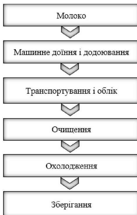
Рисунок 2.5 – Технологічна схема доїння і первинної обробки молока
