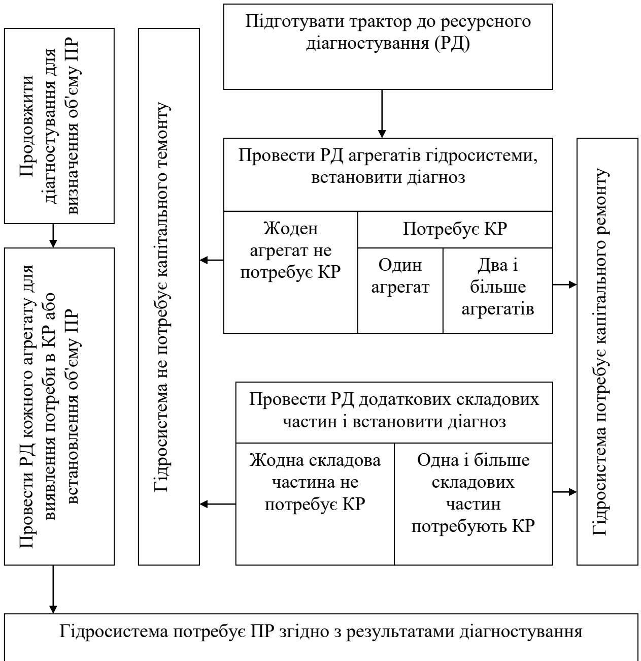
Рисунок 1.1 - Схема проведення ресурсного діагностування гідросистеми
