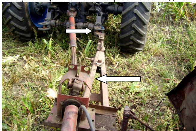
Рис. 20 – Асиметричне приєднання комбайна КСС-2,6 до орно-просапного трактора при зміщеній підшипниковій опорі карданної передачі комбайна
