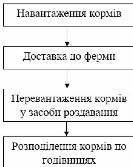
Рисунок 2.1 – Технологічна схема лінії навантаження, доставки і роздавання кормів
