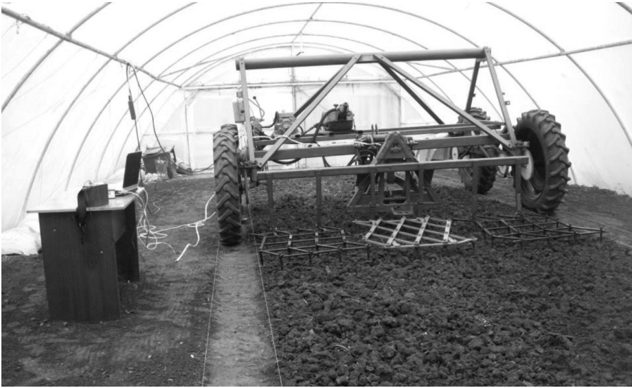
Рис. 1. Мостовий агросасоб під час досліджень у ґрунтовому каналі, який рухається по слідах постійної технологічної колії
