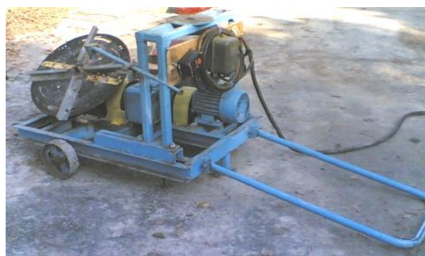
Рис. 1. Загальний вигляд експериментальної установки для дослідження процесу внесення мінеральних добрив відцентровими дисковим тукорозсівним робочим органом, осі якого установлені похило
