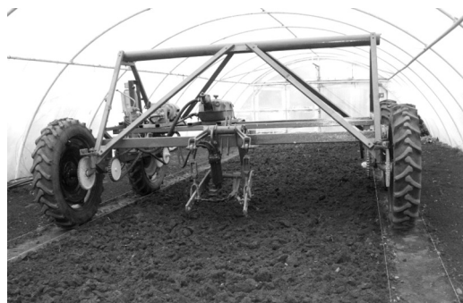
Рис. 1. Мостовий агросасіб із пневматичними колесами, що рухаються по ґрунтових слідах постійної технологічної колії
