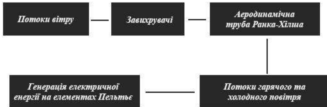
Рис. 2. Блок-схема процесу генерації електричної енергії розробленого вітрогенератора
