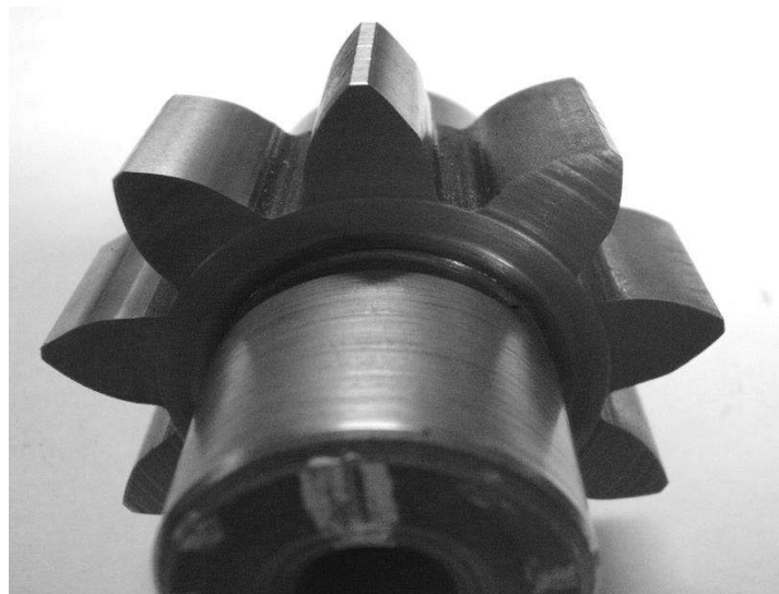
Рис. 3. Характерний дефект цапф шестерень
