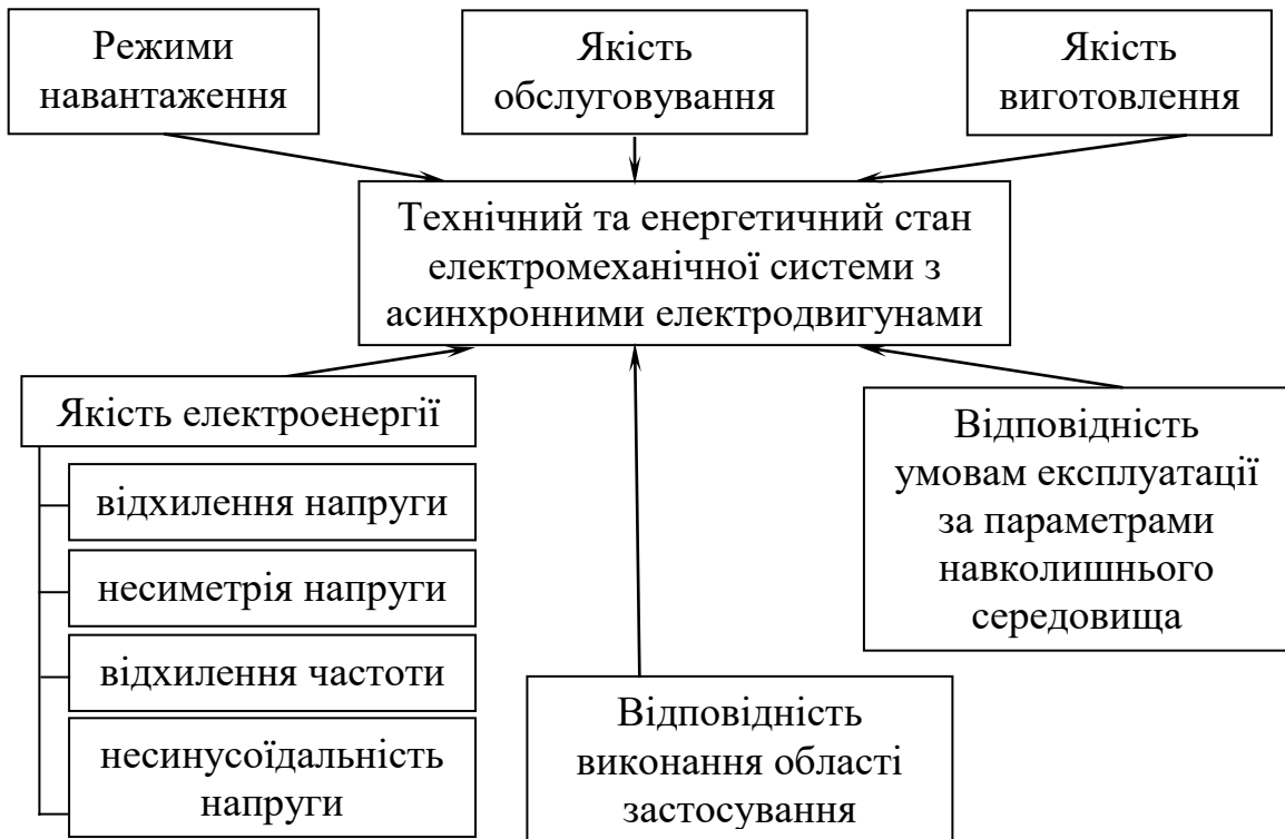
Рис.1. Узагальнена схема впливу експлуатаційних чинників на технічний та енергетичний стан ЕМС з АД
