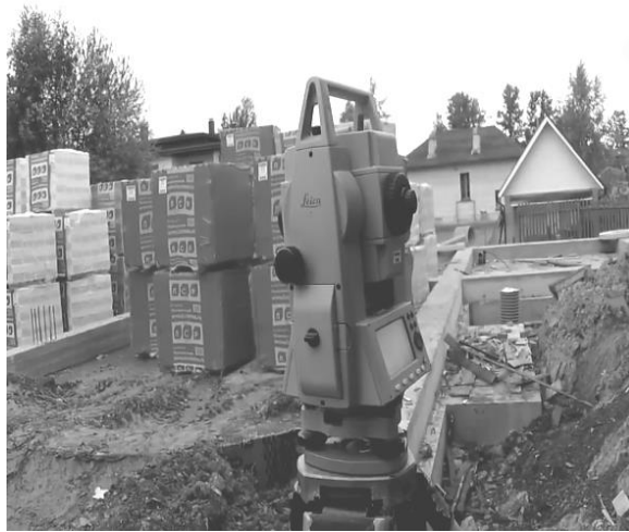
Рисунок 1 – Визначення координат шуканих точок тахеометром
