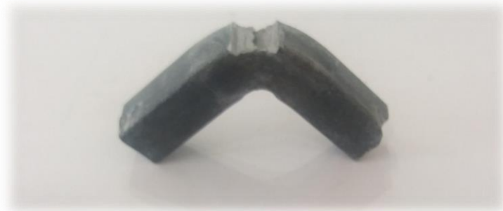
Рисунок 2.29 – Зразок при випробуванні на ударний згин: а) загальний вигляд, б) зруйнований зразок.
