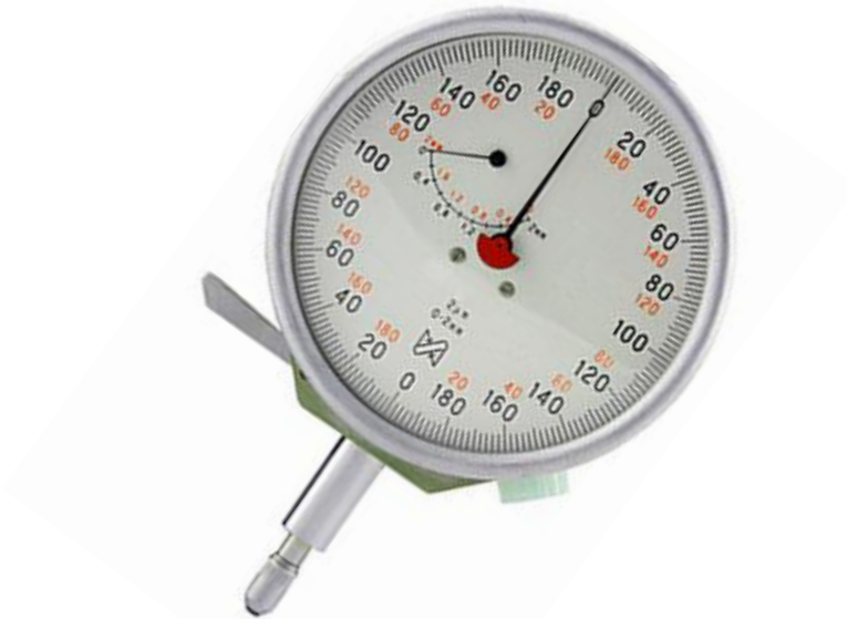
Рисунок 1.13 – Загальний вигляд індикатора багатооборотного типу 1 МИГ.
