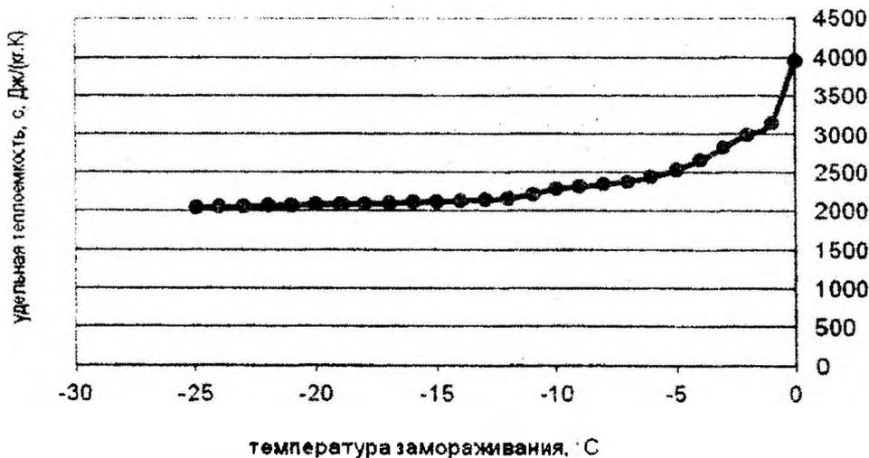
Рисунок 1 - Изменение удельной теплоемкости при замораживании перца сладкого рассыпью в воздушной среде
