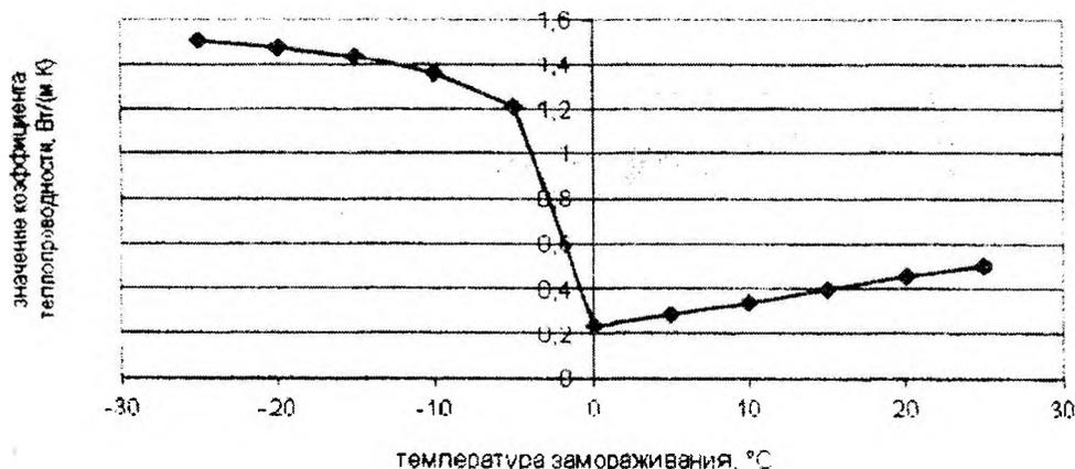
Рисунок 3 - Обобщенная зависимость изменения коэффициента теплопроводности перца сладкого от температуры
