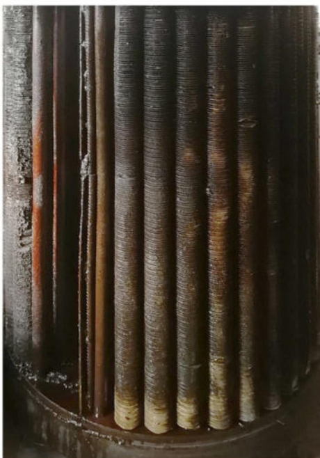
Мал.4. Нагар у міжтрубному просторі кожухотрубного теплообміннику
