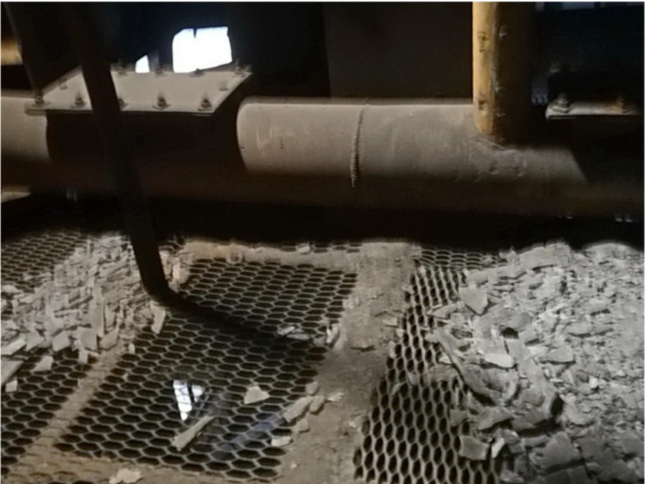
Мал.3. Відкладення після механічного очищення елементів апаратів Вентури
